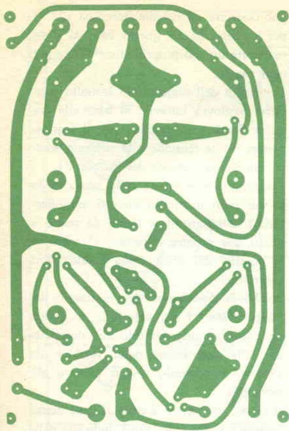
Fig. 2 - Circuito stampato in grandezza naturale e disposizione dei componenti. I rettangoli intorno ai transistori Q3, Q4, Q5, Q6, rappresentano le sagome dei radiatori di calore.
