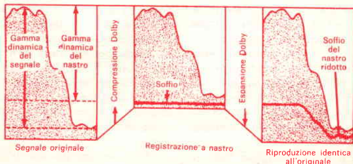
Il sistema Dolby riduce il soffio mediante un processo di compressione ed espansione dei segnali di basso volume; i segnali molto forti non variano.
