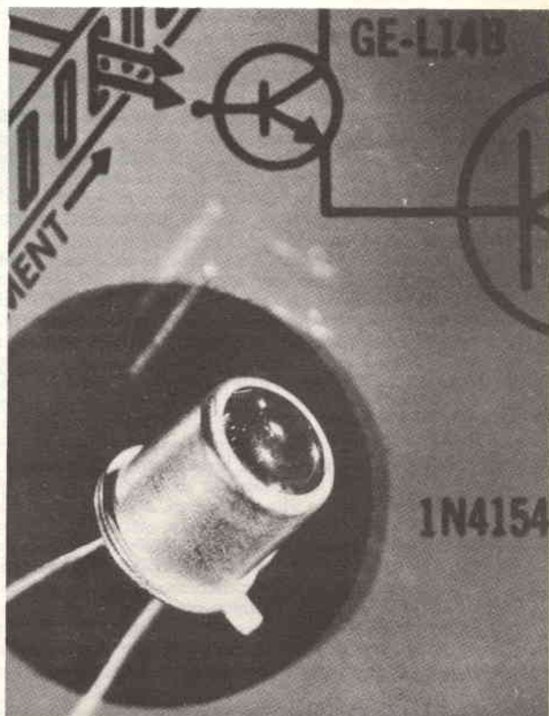
Fig. 4 - Nelle applicazioni pratiche, il LED viene montato, per proteggerlo meccanicamente, entro un involucro metallico simile a quello dei transistori. Un'apertura trasparente consente alla luce di uscire da un'estremità dell'involucro.
